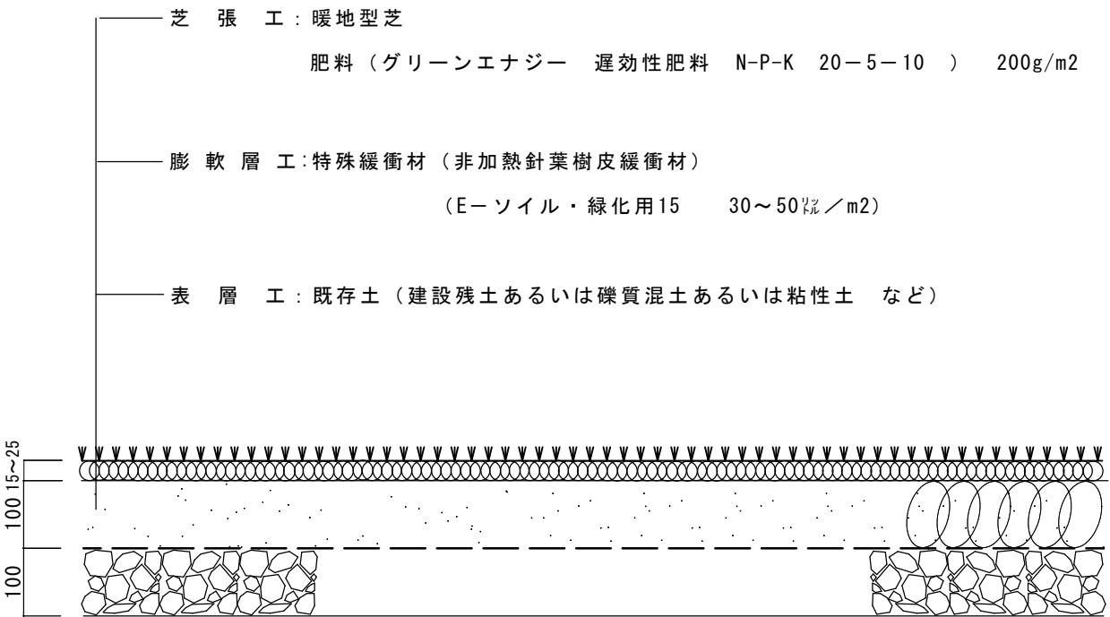
大林式校庭綠化工法（残土利用型）断面図 S=1/10
